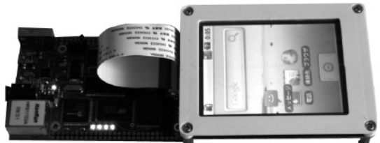
液晶との接続と Android-2.1 が動く様子
